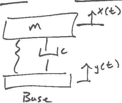
$$m\ddot{x} + c\dot{x} + kx = cY\omega_b \cos\omega_b t + kY \sin\omega_b t$$
